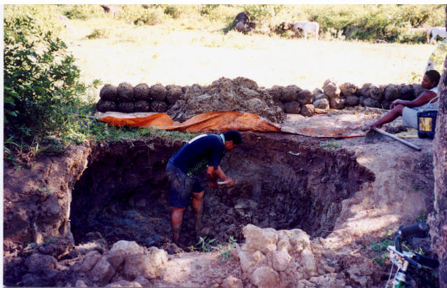
Extração do barro no Vale do Mulembá, vendo-se ao fundo as bolas já prontas
