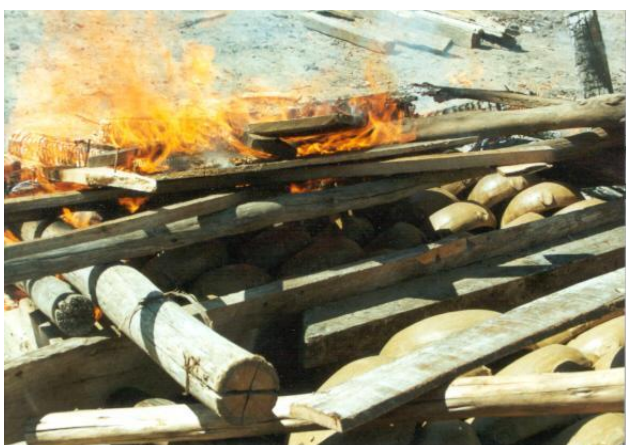
A Queima: ateando fogo à lenha sobre a “cama” e panelas
