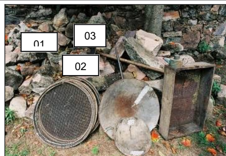
Foto 06. Algumas ferramentas de trabalho do Seu Vadinho. Em destaque: (01) Peneira; (02) carumbé; (03) bateia; (04) enxada; (05) Candeia de Grana; (06) Ralo (F1-A2 2012).
