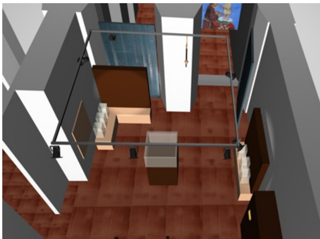
Estrutura de formato retangular perfilados 30X30mm presos a vergalhão com rosca. Spots com lâmpadas halogena PAR-20
