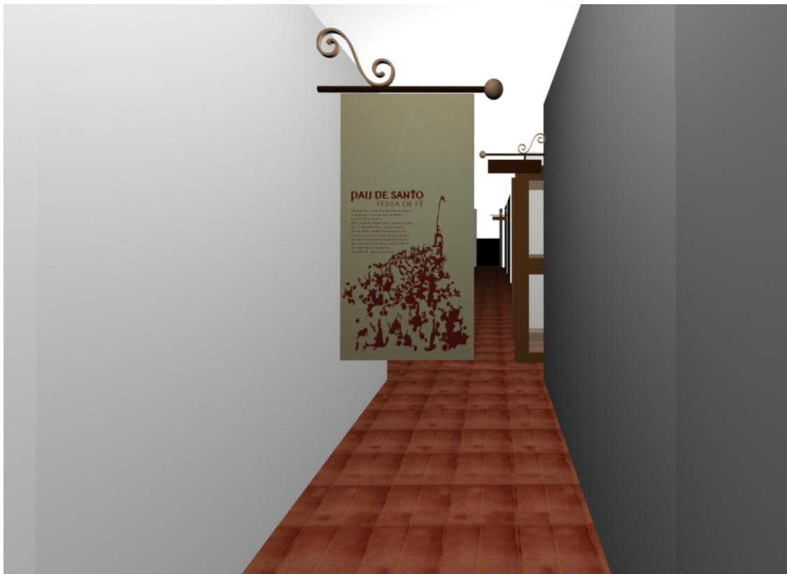
Painel em PVC 3mm com adesivo vinil impressão (CMYK) (frente e verso) e suporte de sinalização em metalon com (pintura automotiva).
