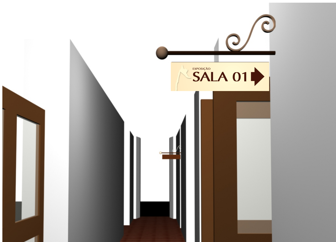
Placa de sinalização em PVC 2mm com adesivo vinil impressão frente e verso (CMYK) e suporte de sinalização em metalon com (pintura automotiva).
